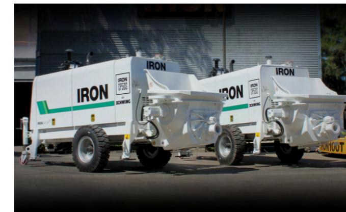
Las bombas estacionarias **IRON** cuentan con tecnología **SCHWING**. Son equipos de construcción utilizados para el bombeo continuo de hormigón. Entre sus ventajas se destacan su alta fiabilidad, fácil mantenimiento y el bajo costo de operación, siendo adecuadas para la construcción de edificios de altura media y alta y para el bombeo de hormigón a largas distancias.
